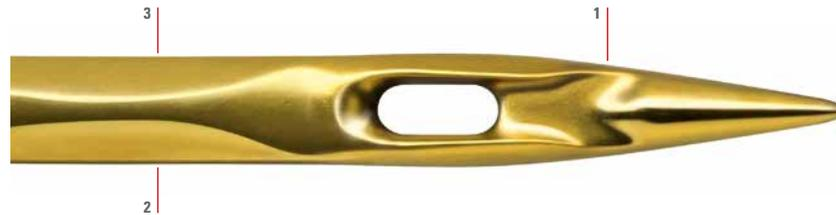
2. Die Hohlkehlfase (Greiferauflauffase) auf der rechten Seite führt zu einer sicheren Schlingenaufnahme durch Standard Horizontal- und Vertikalgreifer.
